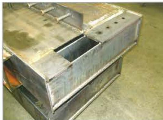
Photo 3 : Fabrication de la poutre de rive / Edge beam fabrication
